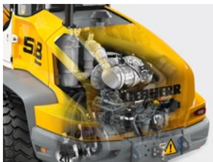
Implantation des composants sur le modèle L 514/L 518
