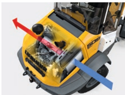
L'installation de réfrigération L 507/L 509
